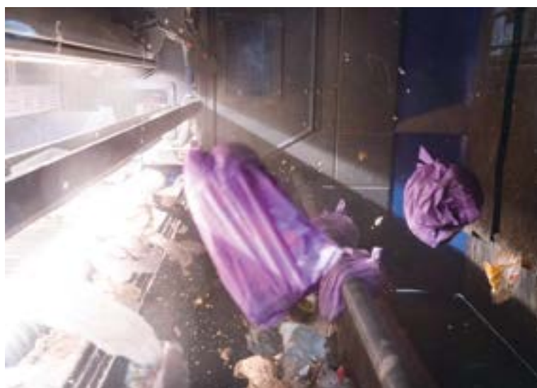
Les sacs mauves sont propulsés par jets d'air pour être séparés des sacs d'ordures.
