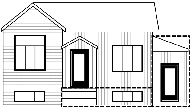
CROQUIS 4 – EXEMPLE D'AMÉNAGEMENT D'UN LOGEMENT D'APPOINT DANS LE SOUS-SOL D'UN LOGEMENT PRINCIPAL
