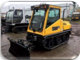
Chasse-neige de trottoir sur chenilles
